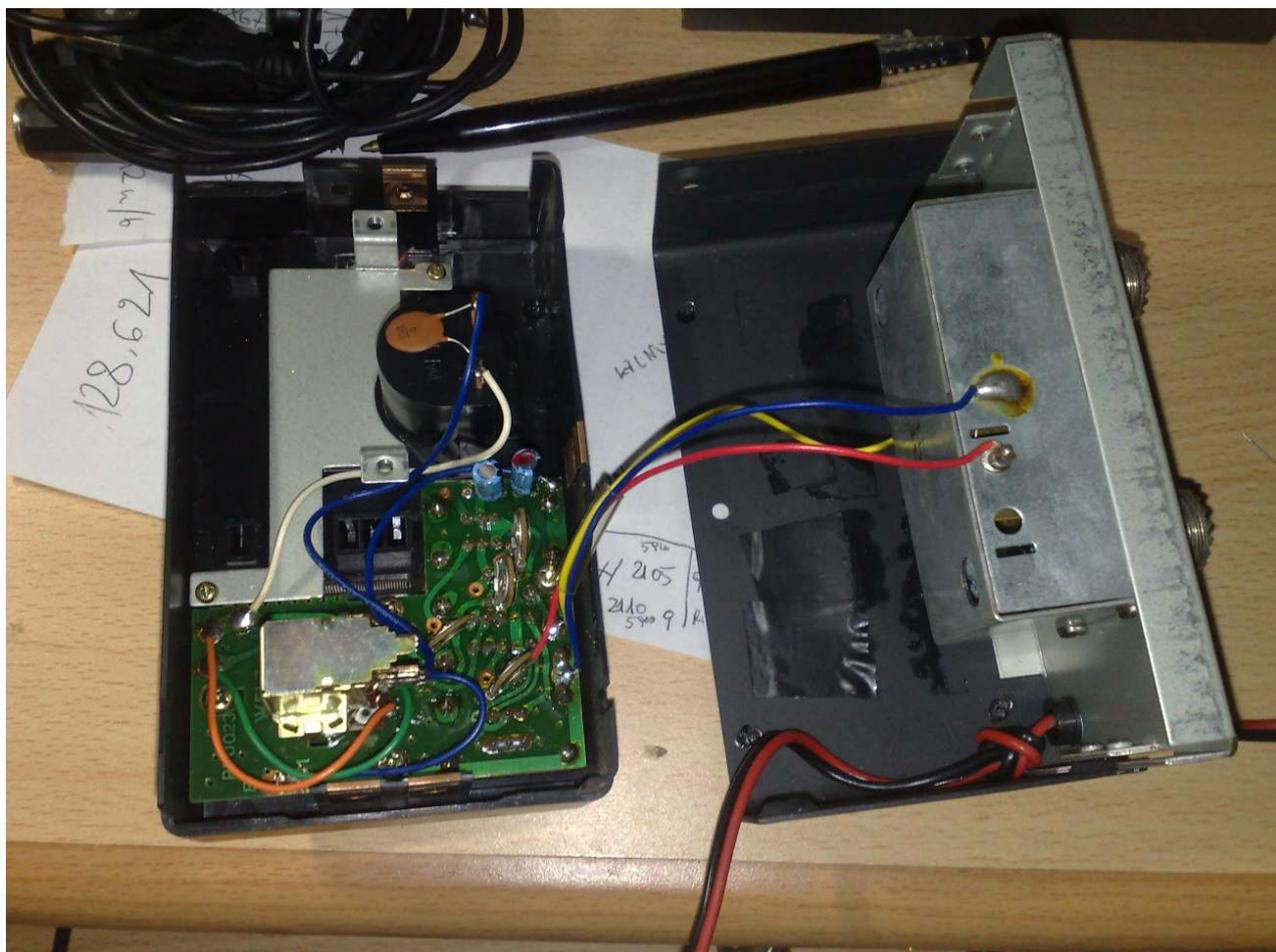
2) Preparate i led: saldate al positivo la resistenza e il relativo cavo di alimentazione così come da foto!
